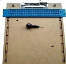
Figura 6 – Conjunto de reglete de mesa com punção 69
